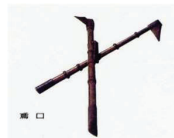
鳶口（とびぐち） 延焼を防ぐために家屋を壊す道具
